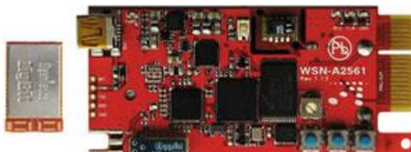
Рисунок 3. Конструктивное оформление мота
