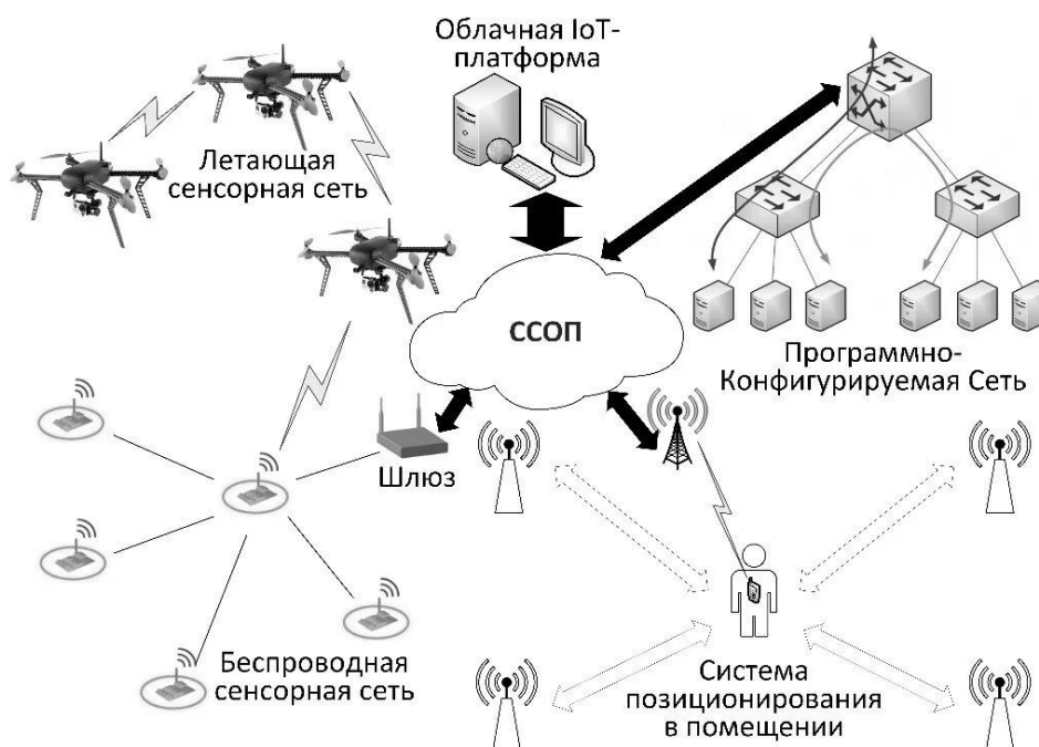
Рисунок 1. Вариант интеграции БСС в облачную IoT структуру
